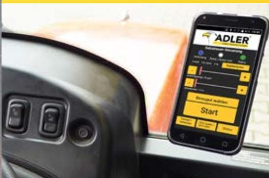
Drehgeschwindigkeit und Ausbringmenge werden bequem per Smartphone aus der Fahrerkabine eingestellt
