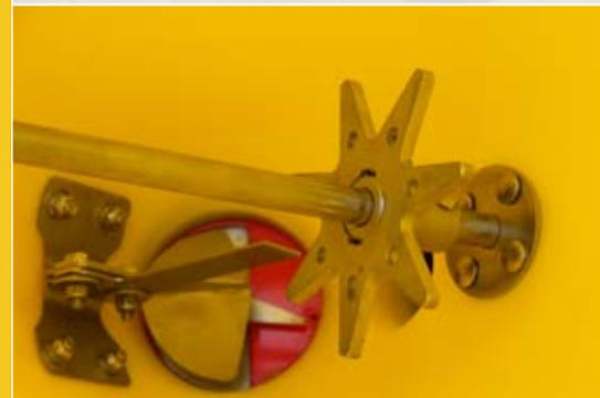
Das von ADLER entwickelte Klopf- und Rührwerk verhindert Brückenbildung beim Streugut
