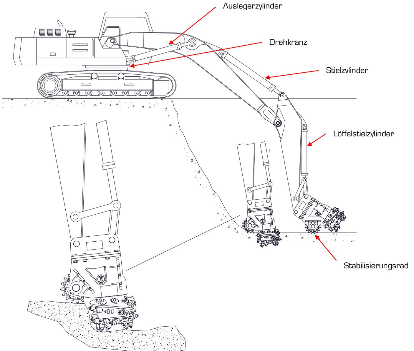
Durch Ausfahren des Löffelzylinders wird die Fräse in den Untergrund gedrückt, da sich die Meissel des Stabilisierungsrad im Boden abstützen.
