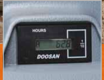
Betriebsstundenzähler (vom Boden aus ablesbar)
