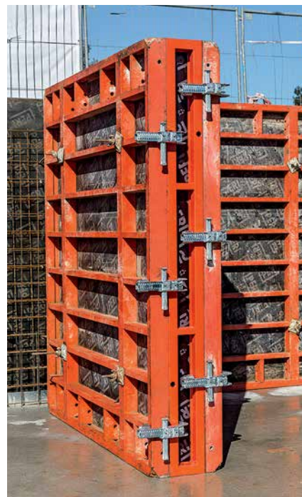
Auch Stirnabschalungen werden einfach und schnell mit dem BFD Schloss erstellt, z. B. bei 24 cm Wandstärke mit dem TRIO Abschalelement.
