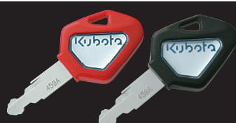
Die Roten -Schlüssel ermöglichen das Programmieren der Schwarzen-Schlüssel, nur mit den Schwarzen - Schlüsseln lässt sich die Maschine starten.
