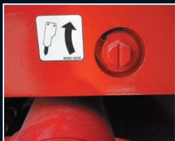
**U**mschaltventil für den drucklosen Rücklauf serienmäßig (Hammerbetrieb).
