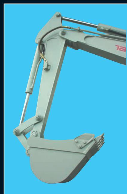
**H**ochdruckabsperrhähne serienmäßig am Löffelstiel montiert. Hydraulikschläuche des Löffelzylinders geschützt im Löffelstiel verlegt.
