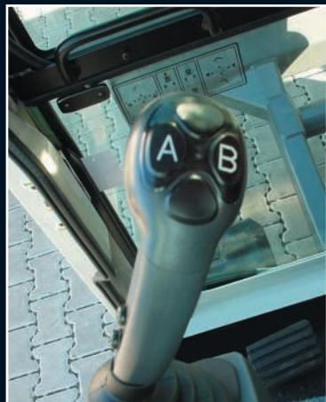
**B**edienung der Zusatz-hydraulik über den linken Joystick
