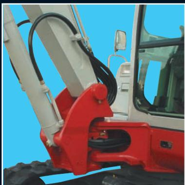
**S**chwenkbock für Hubarm ist in einem Stück gegossen und mit einer mechanisch geschützten Schlauchverlegung versehen. Verwendung von massiven Stahlbuchsen in allen Gelenkpunkten.
