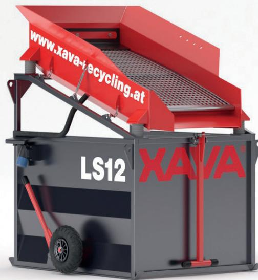
Mit der XAVA LS12 Siebmaschine kann unterschiedlichstes Material gesiebt und recycelt werden. Mit der richtigen Auswahl des Siebelages kann von Kompost über Hackschnitzel, Erde, Schotter, Sand, Bauschutt bis hin zu Ziegelresten oder ähnlichen Materialien alles gesiebt werden. Das Rüttelsieb LS12 ist so konstruiert, dass das gesiebte Material direkt in einen Schubkarren fallen kann.
