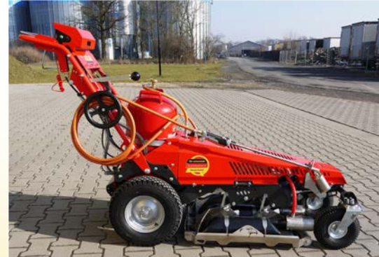
Große Antriebsräder und Differenzial-Getriebe sorgen für eine hohe Wendigkeit und leichtes Arbeiten
