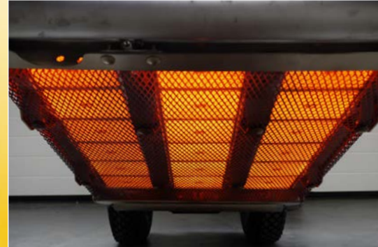
Infrarot-Strahlung ohne offene Flamme!
