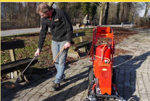
Handbrenner für schwer erreichbare Ecken und Kanten
