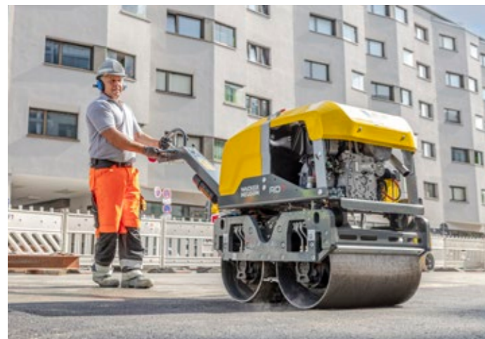
Lange Deichsel erleichtert Lenken und Drehen, besonders auf kleinen Flächen.
