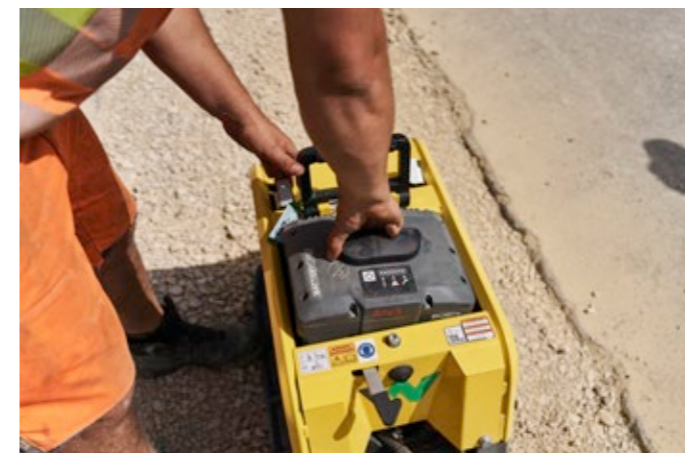
Akku-Wechsel mit nur wenigen Handgriffen.
