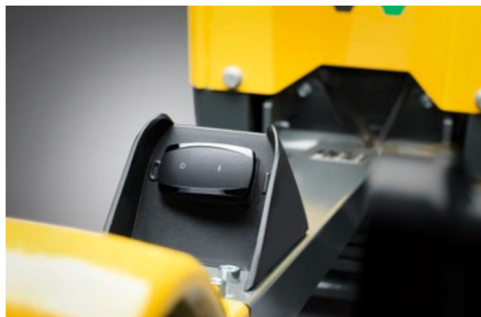
Der Schalter ist für den Bediener gut zugänglich an der Deichsel angebracht.
