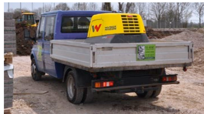
Tiefelader überflüssig: Die DPU130r wiegt nur 1.200 kg und lässt sich auf einer Lkw-Ladefläche transportieren.
