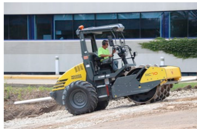
Die Traktionskontrolle sorgt dafür, dass die Räder auch in unebenem Gelände nicht durchdrehen.
