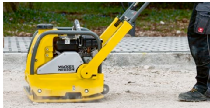
Sehr gut zu manövrieren: dank speziell geformter Grundplatte der WPU1550.
