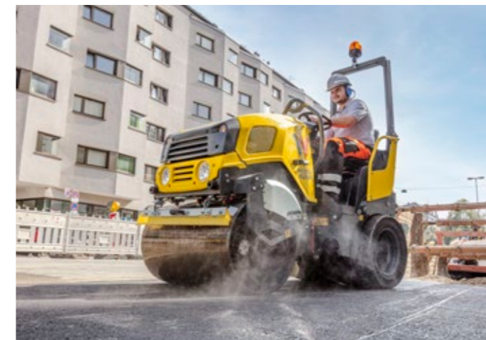
Taillierte Bauform: für freien Blick auf die Bandagenkanten, das Maschinenumfeld und die Baustelle.
