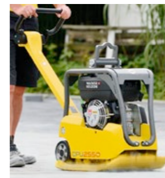
Top-Speed-Version: für hohe Flächenleistung beim Pflasterstein-einbau.
