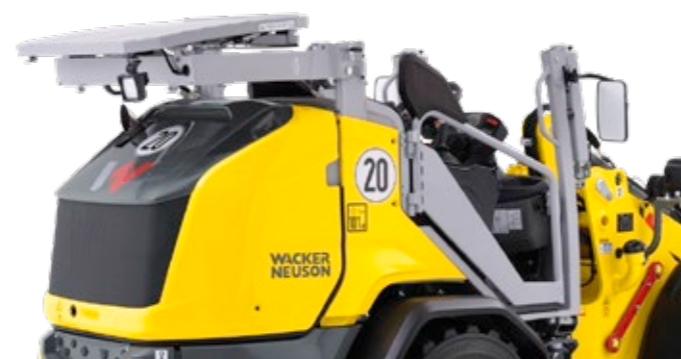
Schnell umgeklappt: das Fahrerschutzdach EPS (Easy Protection System).
