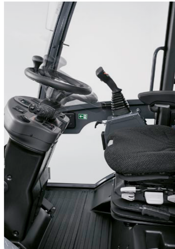
Bequemes Arbeiten: verstellbares Lenkrad und luftgefederter Komfortsitz (optional).
