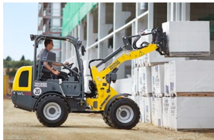
Zuverlässig auch bei schweren Lasten: die in der Breite verstellbare Palettengabel.
