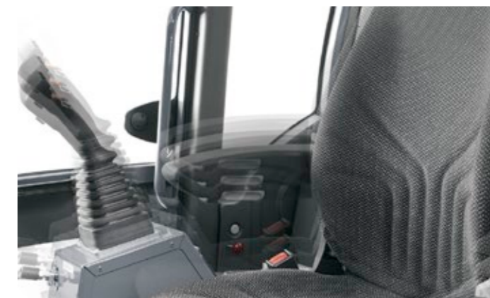
Verstellbare Joystickkonsole am Fahrersitz, die mitfedert.
