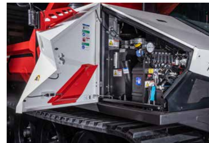
Einfache Kontrolle der Ölstände über Sichtfenster
