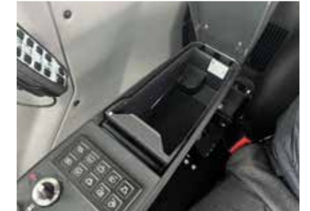
Über das Bedienpanel in der Armlehne können wichtige Fahrzeugfunktionen einfach gesteuert werden. Zudem bietet es Stauraum für Smartphone und Co.
