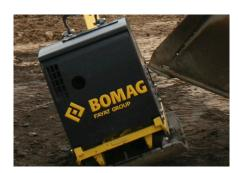
Maximale Langlebigkeit Vollschutzhaube - Motor und Komponenten rundum geschützt
