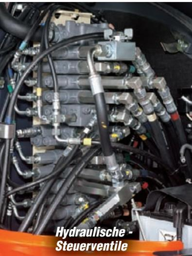
Hydraulische - Steuerventile
