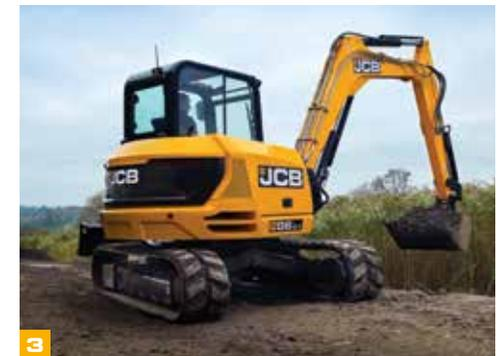
Zusätzlich zu dem vorhandenen robusten Auslegerzylinderschutz sind Schutzabdeckungen für Löffelstiel- und Löffelzylinder optional erhältlich.
