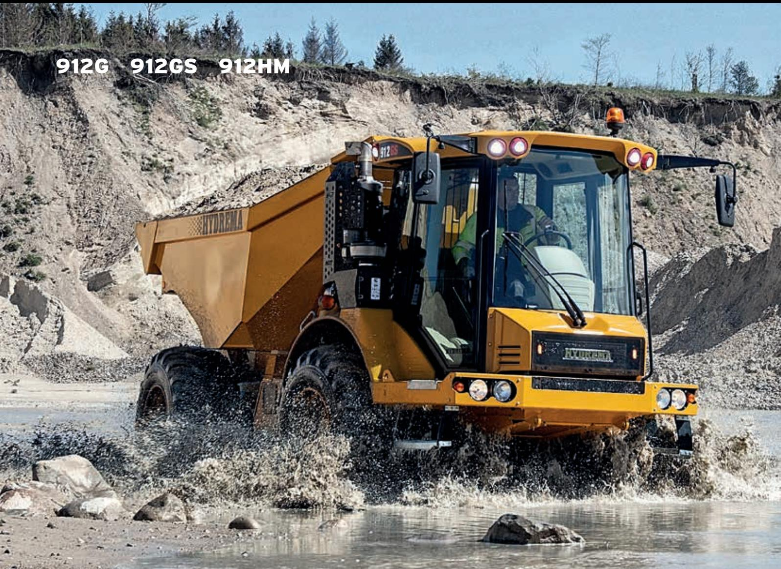
Eine einzigartige Kombination von Knicklenkung, breiten Reifen und eine hohe Bodenfreiheit - ergibt hervorragende Geländegängigkeit!
