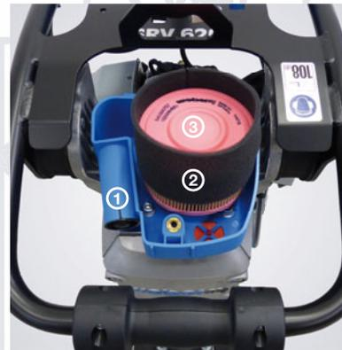
**Maximale Betriebssicherheit.** Mehrfach-Luftfiltersystem mit Zyklonvorabscheider<sup>1</sup>, einem Vorfilter aus Schaumstoff-Vlies<sup>2</sup> und dem Haupt-Filterelement<sup>3</sup>. Der Luftfilter des Motorenherstellers dient der zusätzlichen Sicherheit.
