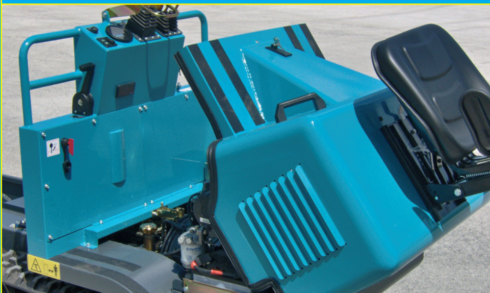
Easy access engine bonnet / Motorhaube für vereinfachte Wartung / K
