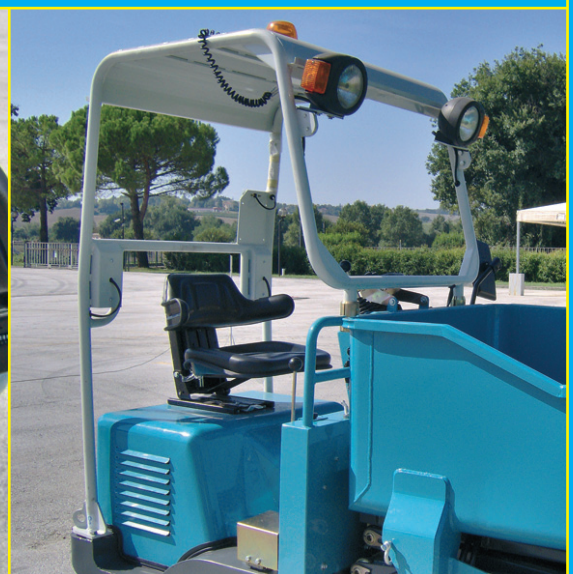
ROPS-FOPS canopy (for on road use also) / Schutzdach ROPS-FOPS mit Strassenzulassung / H ROPS-FOPS ( ☒
