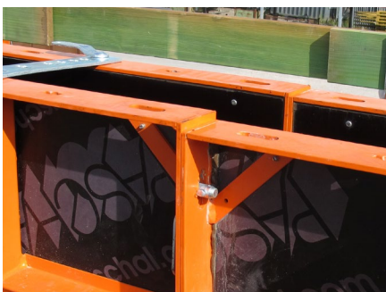
Die in den Elementrahmen integrierten Langlöcher ermöglichen einen Höhenversatz bei unebenen Aufstellflächen von bis zu 2 cm.
