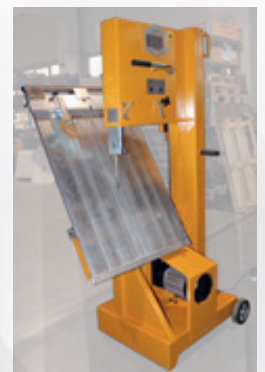
Schneidetisch in Transportstellung
