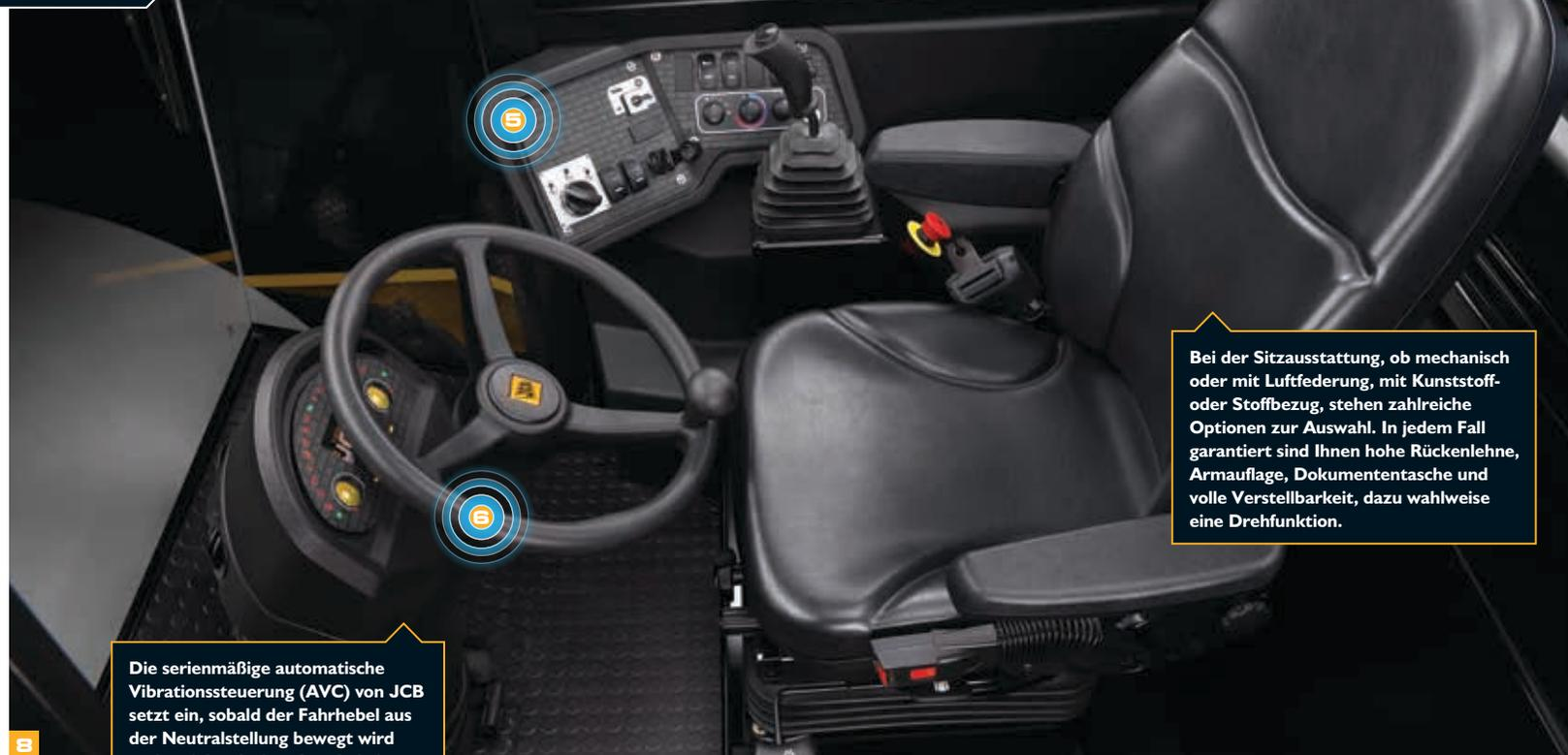
**5** Die serienmäßige automatische Vibrationssteuerung (AVC) von JCB setzt ein, sobald der Fahrhebel aus der Neutralstellung bewegt wird und erzielt sehr komfortabel eine möglichst gleichmäßige Verdichtung.
