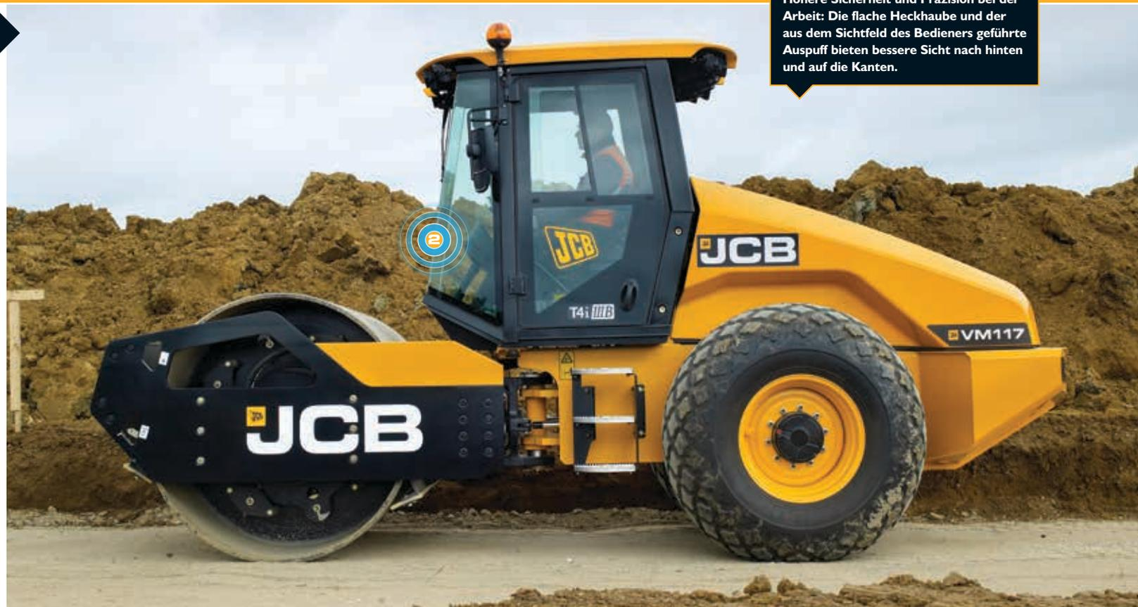
Höhere Sicherheit und Präzision bei der Arbeit: Die flache Heckhaube und der aus dem Sichtfeld des Bedieners geführte Auspuff bieten bessere Sicht nach hinten und auf die Kanten.
