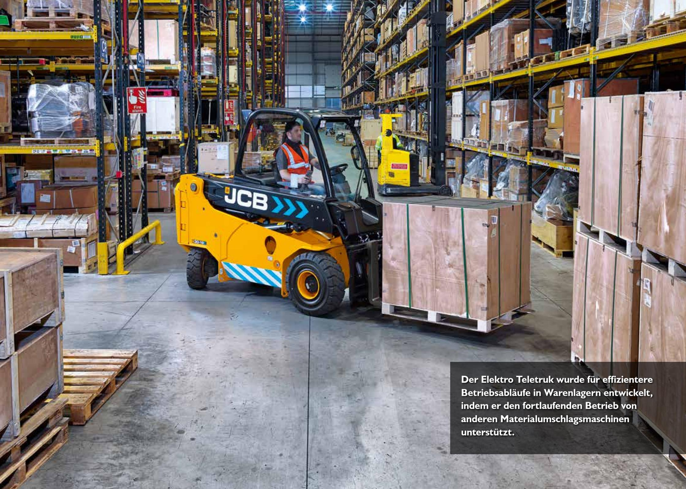
Der Elektro Teletruk wurde für effizientere Betriebsabläufe in Warenlagern entwickelt, indem er den fortlaufenden Betrieb von anderen Materialumschlagsmaschinen unterstützt.
