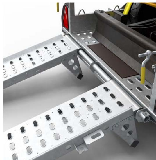
● **Verstellbare Einzelrampen** bieten einen geringen Auffahrwinkel für Fahrzeuge aller Art. Gefertigt aus feuerverzinktem Stahl und für mehr Grip mit Löchern versehen. Scharnierabdeckungen aus Nylon sorgen für eine geräuscharme Handhabung und verringern Abrieb.
