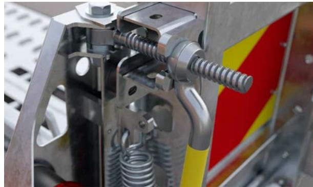
● **ACME Verschlussystem.** Schließt lautlos - die Laderampen werden durch Sicherheitsklemmverschlüsse an ihrem Platz gehalten. Ein Gummipuffer ist Teil des Systems und dämpft Geräusche, die während der Fahrt auftreten könnten.
