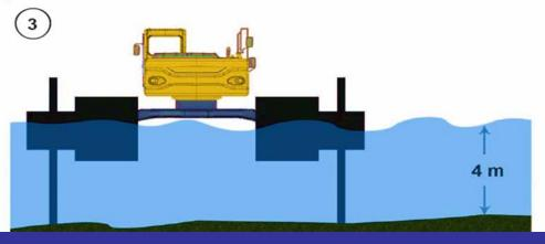
Einsatzprinzip bei einer Tlefe bis 4 m mit zusätzlichen Pontons. Der Bagger kann auch so konstruiert werden, dass er Arbeiten über 4 m Tiefe erlaubt.
