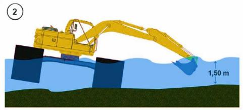
Einsatzprinzip bei einer Tlefe von 1,50 m. Beim Ausgraben stützt sich der Bagger mit Hilfe der Pontons am Grund und stabilisiert sich so. Die Arbeit um 360° ist auch gegeben.
